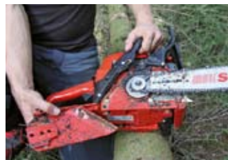
Die innenliegende Kupplung erlaubt einen leichten Kettenwechsel.
