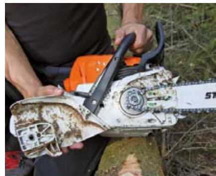
Die innenliegende Kupplung sorgt für einen guten Spanabfluss auch beim Längsschnitt.
